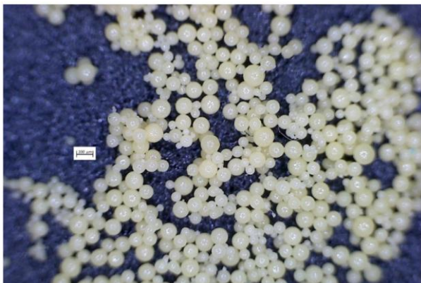
Na Wydziale Inżynierii Lądowej opracowano mikrokapsułki żelatynowe zawierające środek naprawczy, który ma zdolność do zasklepiania mikroskradków w nawierzchniach drogowych
