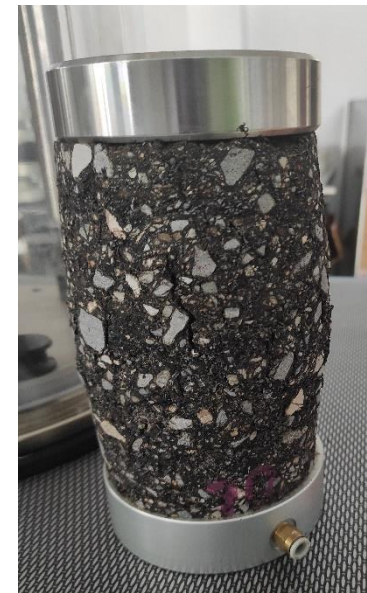
Ocena kohezji - mieszanka BSM poddana badaniu odporności na deformacje trwałe Flow Number
